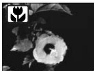
**MACRO** – Utilisé pour photographier de près, entre 20 et 60 cm de distance depuis le capteur CCD. L'objectif zoome automatiquement en position macro et ne peut être modifié. À cause de la parallaxe, il est recommandé de cadrer à partir de l'écran ACL. L'AF en continu (p. 65) est employé. Le programme macro est disponible en mode Enregistrement Multifonction.
