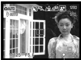
L'indicateur de mise au point situé dans le coin inférieur droit de l'écran ACL et le témoin vert à côté du viseur indiquent la mémorisation du point.
