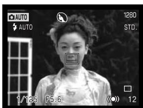
Appuyer à mi-course sur le déclencheur. Le système AF localise le sujet et la sélection automatique de programme détermine celui qui est le mieux adapté à la scène. Si aucun icône ne s'affiche, cela signifie que c'est le programme général qui a été sélectionné. Appuyer à fond sur le déclencheur pour prendre la photo.
