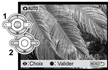
Composer l'image comme décrit dans le chapitre des opérations de base (p. 26). Appuyer à mi-course sur le déclencheur (1) pour mémoriser la mise au point et l'exposition du sujet pour la série. Appuyer à fond sur le déclencheur et le maintenir (2) pour réaliser les trois vues successives. La mise au point est mémorisée sur la première image
