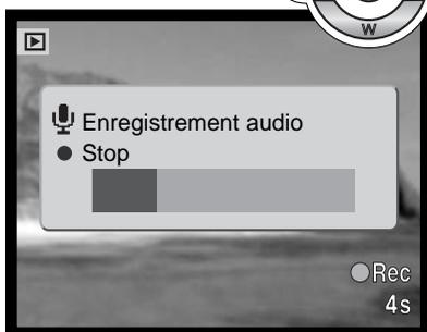
L'enregistrement de la légende audio peut être interrompu en appuyant sur la touche centrale du contrôleur (1).
