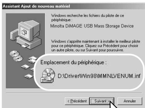
Le programme d'installation de périphérique confirme le répertoire d'installation du pilote. Cliquer sur "Suivant" pour installer le pilote.
