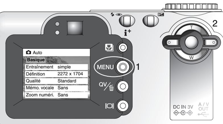
Une fois qu'un réglage a été sélectionné, le pointeur revient aux options de menu et le nouveau réglage est affiché. D'autres modifications peuvent être effectuées.
