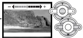
Utiliser les touches gauche/droite pour régler la luminosité. Appuyer sur la touche centrale pour valider le réglage.
