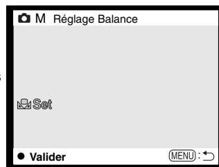
Le réglage personnalisé reste actif jusqu'à ce qu'une nouvelle calibration soit effectuée ou que le mode de réglage de balance des blancs soit modifié. Pour rappeler le réglage personnalisé, sélectionner Rappeller. dans l'option balance des blancs du menu. Le précédent réglage personnalisé est alors appliqué.
