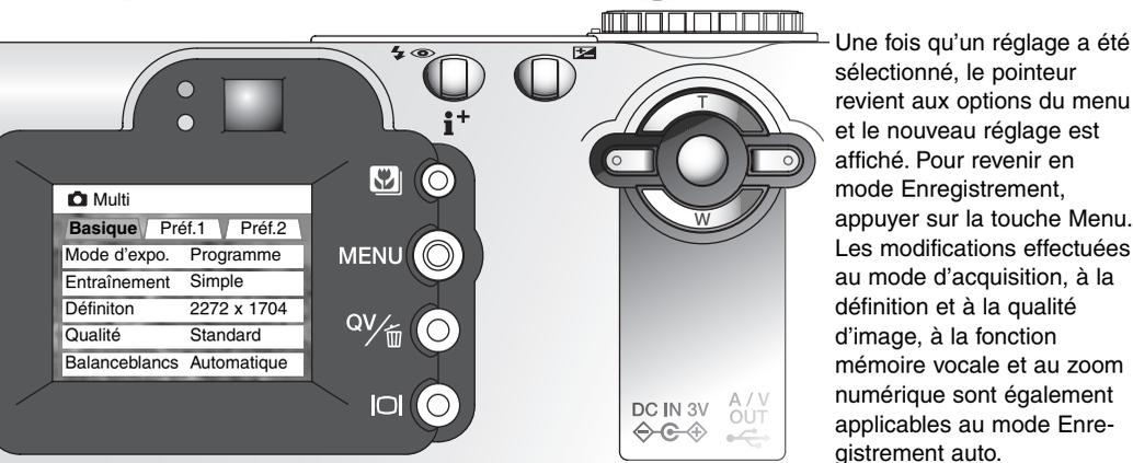
Une fois qu'un réglage a été sélectionné, le pointeur revient aux options du menu et le nouveau réglage est affiché. Pour revenir en mode Enregistrement, appuyer sur la touche Menu. Les modifications effectuées au mode d'acquisition, à la définition et à la qualité d'image, à la fonction mémoire vocale et au zoom numérique sont également applicables au mode Enregistrement auto.
