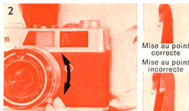
cadre lumineux correspond exactement à l'image qui sera impressionnée sur le film. Ce cadre est couplé au télémètre de sorte que la parallaxe est automatiquement corrigée.
