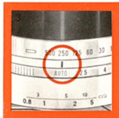
4. Ajuster le levier de réglage de la sensibilité du film sur un des trois symboles de pose en tournant la bague de réglage des vitesses.
