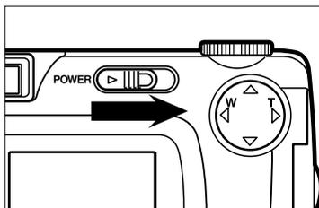
**4** Agir sur l'interrupteur principal pour mettre l'appareil sous tension.
