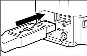
**5 Ouvrir le couvercle des connecteurs et raccorder le câble USB au connecteur USB de l'appareil.**
