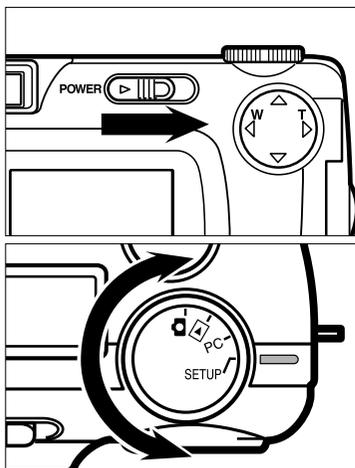
**1** Placer le sélecteur sur
