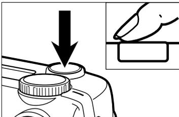
**8** Appuyer à fond sur le déclencheur et le maintenir enfoncé.
