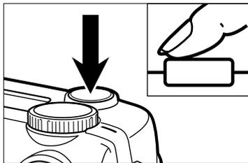
\* Lors de la pression sur le déclencheur, on contacte qu'il existe un palier à mi-course. Les descriptions de ce mode d'emploi font référence à ce palier par la formule "appuyer à mi-course sur le déclencheur" ou "lorsque le déclencheur est enfoncé à mi-course".
