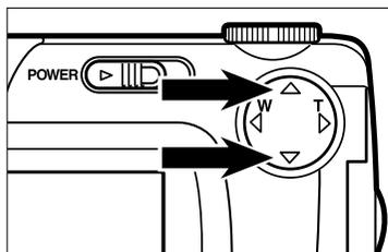
**5 Régler la mise au point avec ▲ ou ▼ tout en contrôlant l'image sur le moniteur ACL.**
