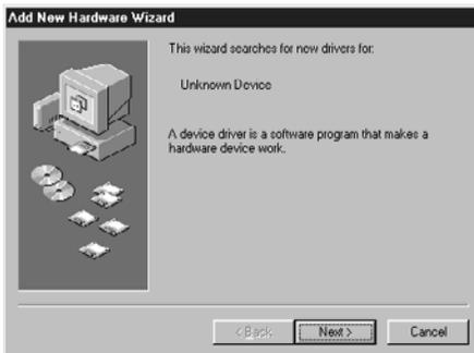
Avec Windows®98/Windows®98 Second Edition et une connexion de l'appareil par câble USB, la boîte de dialogue, "Ajouter un nouveau périphérique inconnu" apparaît à l'écran du micro-ordinateur comme indiqué sur la figure ci-contre. Installer le logiciel pilote en suivant les indications fournies à l'écran (voir procédure décrite pages suivantes).
