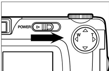
**2** Pousser l'interrupteur principal vers la droite pour mettre l'appareil sous tension.
