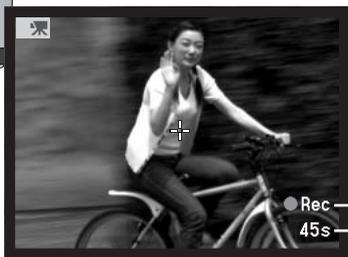
La prise de vues vidéo est simple. Placer le repère du capteur en croix sur le sujet. Appuyer à fond sur déclencheur et le relâcher pour lancer la séquence (2). L'appareil enregistre les images jusqu'à ce que la séquence ait atteint 60 secondes ou jusqu'à une nouvelle pression sur le déclencheur. Durant l'enregistrement, le compteur de l'écran de contrôle et de l'écran ACL décompte le temps restant.
