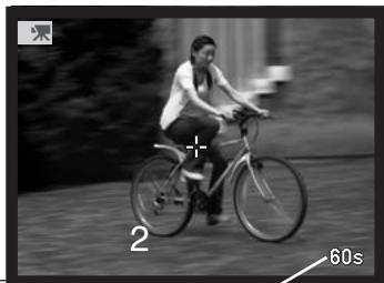
Placer le sélecteur de mode en position Enregistrement vidéo (1) En dehors de la période d'enregistrement, les compteurs indiquent la durée maximale disponible. Elle est de 60 secondes tant que l'espace disponible sur la carte CompactFlash est suffisant. Lorsqu'il n'y a plus assez de place pour enregistrer une séquence de 60 secondes, c'est le temps correspondant à l'espace disponible qui est affiché.
