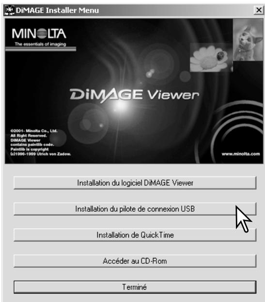
Avant de connecter l'appareil au micro-ordinateur, Charger le CD-Rom du logiciel DIMAGE dans le lecteur de CD-Rom. Le menu d'installation est automatiquement initialisé. Pour installer automatiquement le pilote USB Windows 98, cliquer sur le bouton de lancement de l'installation de périphérique USB. Un fenêtre apparaît pour confirmer que le pilote doit être installé. Cliquer sur "Oui" pour continuer.
