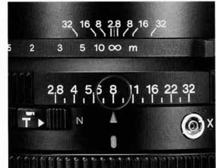
Pour régler une ouverture, il suffit de tourner la bague des diaphragmes et de placer le chiffre choisi en l'index central. Il est possible d'utiliser des positions intermédiaires entre deux valeurs marquées par un cran.
