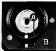
1. Pour une utilisation normale, faire coïncider le point blanc de la bague du déclencheur @ avec celui situé sur le bouton au-dessous (B). Dans ce cas, le déclenchement est électromagnétique et toutes les sécurités électriques fonctionnent.
