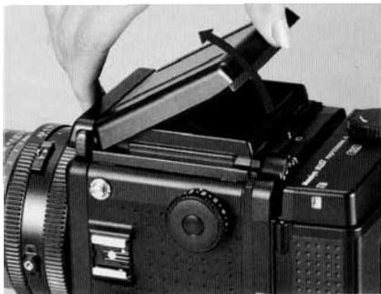
Soulever simplement l'arrière du viseur jusqu'à ce qu'il s'ouvre entièrement.
