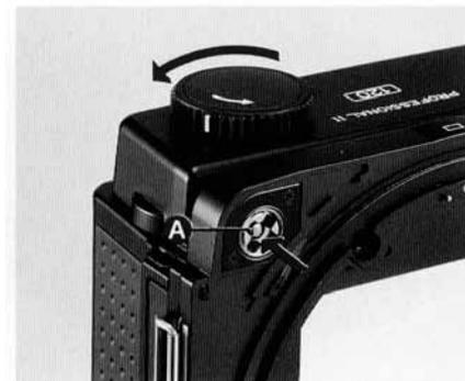
Si vous souhaitez développer un rouleau partiellement utilisé, il faut d'abord retirer le dos après avoir mis en place le volet. Ensuite, tout en maintenant une pression au centre du coupleur (A), enrôler le film entièrement avec le bouton d'avancement.
