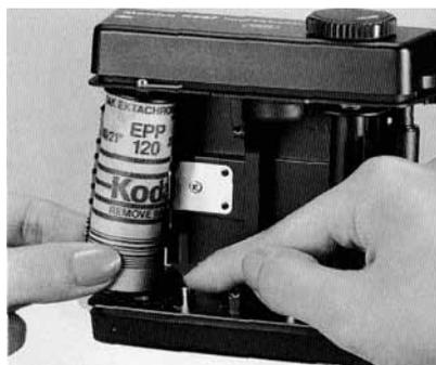
En maintenant abaissé la tige de dégagement du côté gauche, placer un rouleau entre les supports supérieurs et inférieurs de la bobine située à gauche. Tirer la bande amorce dans la direction de la flèche et des pointillés autour du support, puis pardessus le rouleau, ensuite sur partie arrière du porte-film. La faire passer sur le rouleau de droite et l'insérer dans la bobine réceptrice. Lorsque le film est
