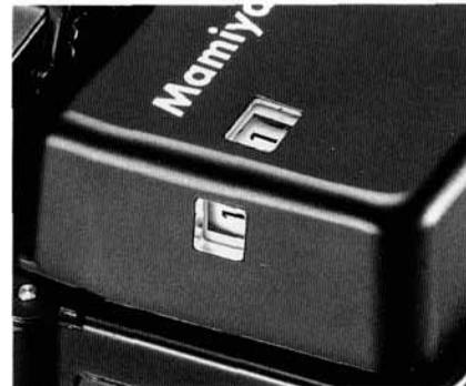
Le film est en place pour la prise de vue quand le numéro 1 est visible au compteur de vues et quand le signal rouge disparaît. Durant l'avancement du film de position S (début) à 1 avec le levier d'armement, l'obturateur est automatiquement verrouillé. Comme il y a 2 compteurs d'exposition (1 vertical et 1 horizontal) on peut à tout moment contrôler le nombre d'expositions effectuées.
