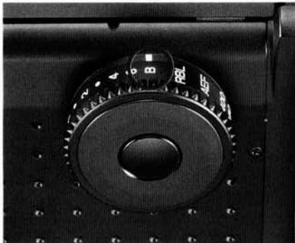
Lorsque le barillet des vitesses est placé sur (B), l'obturateur reste ouvert aussi longtemps que l'on appuie sur le déclencheur. Grâce à la commande électronique, il se ferme automatiquement après une minute de manière à sauvegarder la pile. Sur position (B), une alarme sonore retentit environ 50 secondes, après le déclenchement.
