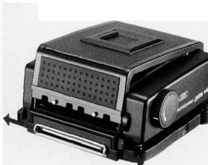
Tirer sur les loquets du haut et du bas pour ouvrir le fond. Par sécurité, le magasin ne peut s'ouvrir que si les deux fermetures sont tirées. Lorsque le magasin est ouvert, retirer le porte-film. Pour mettre le film en place, il n'est pas nécessaire de retirer le magasin de l'appareil. Il faut toujours éviter la lumière directe du soleil. Opérer à l'ombre ou dos au soleil.
