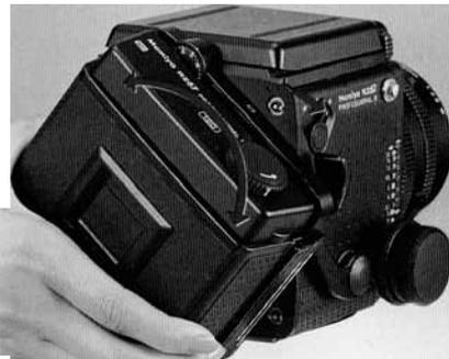
Pour modifier la position du dos, il faut placer le levier RM sur "R". Pour passer du cadrage horizontal au cadrage vertical, tournez le dos dans le sens des aiguilles d'une montre jusqu'à ce qu'il bute. Tourner en sens inverse pour revenir au cadrage horizontal.
