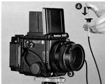
1. Après avoir placé un câble déclencheur sur la prise du miroir, l'embase se soulevra légèrement et l'appareil sera prêt pour le relevage du miroir.
