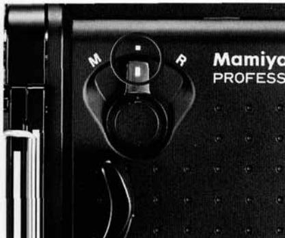
Avant d'essayer d'avancer le film jusqu'à la première vue, vérifiez que le levier RM est sur sa position normale (centre). S'il se trouve sur "M" (surimpression) le film n'avancera pas en appuyant sur le levier d'armement.
