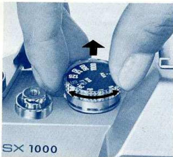
Soulever la bague extérieure du bouton des vitesses et la tourner dans un sens ou dans l'autre jusqu'à faire apparaître dans la fenêtre la sensibilité correspondant à celle du film utilisé, et qui est généralement indiquée sur l'emballage ou la notice du film.
