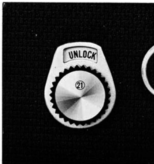
Faire tourner le bouton de mise au point (8) et rentrer le soufflet de telle sorte que le verrou de l'objectif (22) soit le plus près du corps de l'appareil. Faire tourner le bouton de changement d'objectifs (21) vers la gauche jusqu'à ce que le mot "UNLOCK" apparaisse dans la fenêtre.
