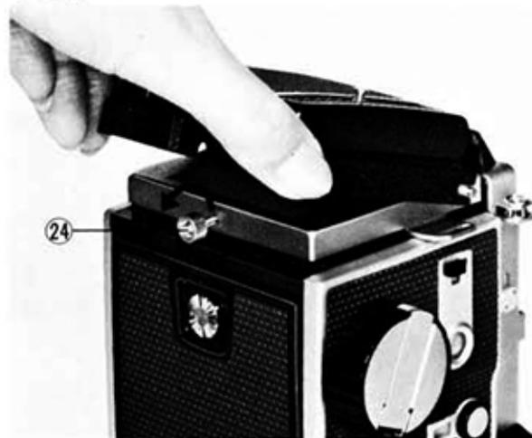
Le capuchon de mise au point peut être remplacé par divers viseurs disponibles pour cet appareil en tant qu'accessoires.
