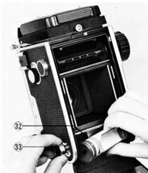
**2.** Tirer le bouton de changement de bobine (33) et mettre en place un rouleau de pellicule dans le logement (32).
