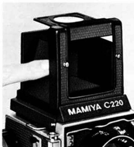
**2.** Pour ramener le volet du viseur sportif (12) il suffit d'appuyer légèrement vers l'intérieur sur la plaque latérale du capuchon (sur le côté du bouton de bobinage de la pellicule) et le volet reviendra automatiquement à sa position d'origine.
