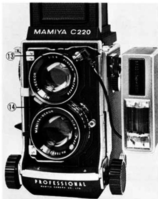
Pour tenir l'appareil à la main en photographiant au flash, fixer une poignée à l'écrou de pied (27) sur le corps de l'appareil et monter le flash sur la patte d'accessoire en haut de la poignée. Brancher le cordon dans la prise synchro de flash (13).
