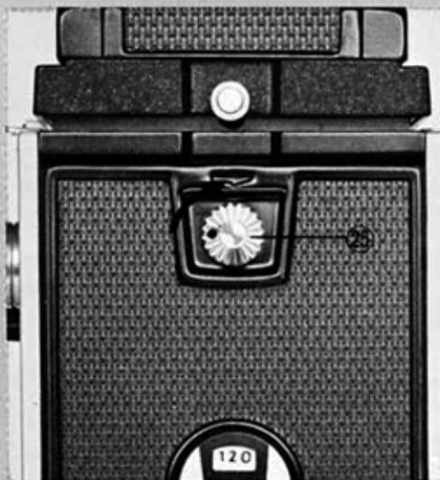
Faire tourner le bouton de verrouillage (25) du dos jusqu'à ce que le repère rouge sur le bouton soit en haut. Puis en appuyant sur le bouton dans la direction indiquée sur le dos, le dos s'ouvrira. Le chiffre sur le compteur de vues revient automatiquement sur "0" lorsque l'on ouvre le dos.
