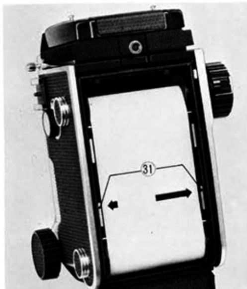
**3.** Tirer la bande de papier d'amorce de la pellicule et la guider dans la fente de la bobine réceptrice, faire tourner vers la droite le bouton d'entraînement de la pellicule (4) jusqu'à ce que le repère de départ sur le papier coïncide avec le repère départ (31) sur l'appareil, fermer alors le dos.
