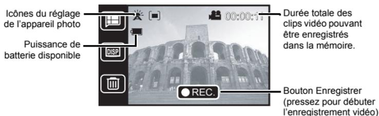
3. Cadrez le sujet avec l'écran LCD et tapotez sur le bouton Enregistrer pour débuter l'enregistrement vidéo. Vous pouvez également presser OK (pousser le bouton de Navigation) ou le bouton déclencheur pour débuter l'enregistrement.
