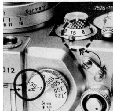
3. **Pour les temps de pose plus longs que  $\frac{1}{30}$  de sec., dans le cas des lampes-éclairs ou du flash électronique,** on règle le barillet des instantanés rapides sur le signe  $\downarrow$  rouge et le barillet des instantanés lents d'après le temps de pose choisi (fig. 3).
