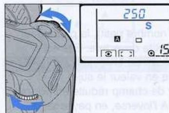
**3** Tourner l'une des molettes pour sélectionner la vitesse d'obturation désirée.
