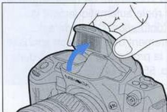
Lorsque le flash est en service, l'éclair est émis à chaque déclenchement. L'exposition est assurée par le système de contrôle TTL de l'appareil.
