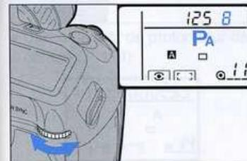
PA : Tourner la molette arrière jusqu'à ce que l'ouverture souhaitée apparaisse à l'écran et dans le viseur. L'indication "PA" s'affiche à l'écran.
