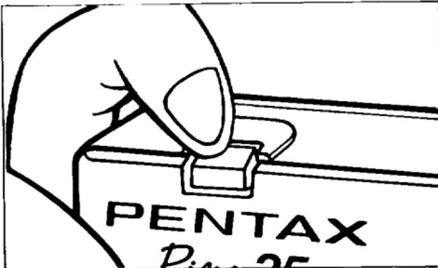
**3** Den Auslöser vorsichtig halb durchdrücken. Wenn die LED-Signallampe nicht aufleuchtet, kann die Aufnahme durch vollständiges Durchdrücken des Auslösers gemacht werden.
