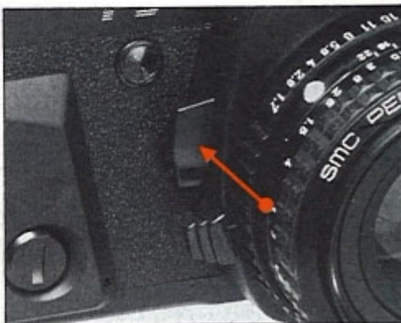
Vous pouvez fermer l'objectif à son ouverture présélectionnée en appuyant sur le levier de contrôle de profondeur de champ. Vous pouvez alors contrôler la netteté de l'image dans le viseur par observation directe sur le dépoli de tous les éléments de la photo. Après ce contrôle, le diaphragme s'ouvre à nouveau à sa plus grande ouverture dès que vous relâchez la pression sur le levier. Il est impossible de contrôler la profondeur de champ lorsque l'appareil est en mode «programme».
