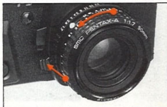
Suivez la procédure ci-dessous pour monter ou retirer un objectif en monture K, KA ou Kf.
