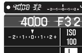
Si l'exposition appropriée dépasse les valeurs de vitesse et d'ouverture disponibles, celles-ci s'affichent en clignotant. Dans des conditions de trop forte luminosité, utiliser un filtre gris neutre monté sur l'objectif, régler la sensibilité (ISO) de l'appareil sur une valeur inférieure, ou, en cas de lumière artificielle, réduire l'intensité de l'éclairage. Dans des conditions de luminosité insuffisante, utiliser le flash intégré ou augmenter la sensibilité de l'appareil (ISO).
