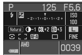
Lorsqu'une correction est appliquée (réglage différent de 0), un indicateur et la valeur sont affichés sur l'écran. Le contrôle des effets numériques ne peut être utilisé qu'en modes d'exposition P, A, S, et M.
