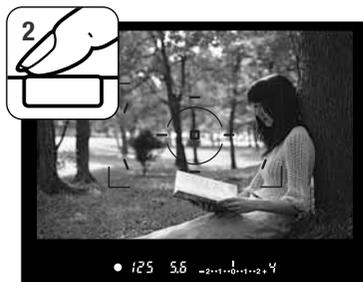
Sans relâcher le déclencheur, recadrer la scène pour décentrer le sujet principal dans le viseur. Appuyer ensuite à fond sur le déclencheur (sans l'avoir préalablement relâché) pour prendre la photo (2).
