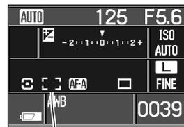
Les modes zone AF contrôlent les zones AF actives utilisées pour la mise au point. Ces modes sont sélectionnés à l'aide de la touche fonction (p. 56). La zone AF active s'affiche à l'écran.
