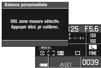
Un message apparaît. Si le déclencheur est appuyé à mi-course, l'affichage écran réapparaît. L'indicateur de réglage personnalisé s'affiche en rouge dans le panneau de balance des blancs. Mettre la molette de balance des blancs sur une autre position pour annuler la procédure.
