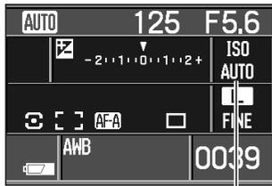
La sensibilité de l'appareil peut être modifiée. La correspondance de zone dans les hautes ou basses lumières peut être activée. Le réglage de sensibilité s'affiche à l'écran. Appuyer sur la touche sensibilité de l'appareil (1) pour ouvrir l'écran de réglage.
