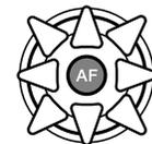
Lorsque la sélection zone AF ponctuelle est active, utiliser le contrôleur pour sélectionner la zone AF ponctuelle souhaitée ; la mise au point automatique (autofocus) est activée et verrouillée chaque fois qu'une nouvelle zone AF ponctuelle est sélectionnée. La touche centrale sélectionne la zone spot AF. La mise au point reste verrouillée après la prise de vue jusqu'à ce que le contrôleur soit relâché.
