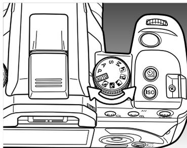
Tourner la molette de sélection de l'exposition en position mode Auto ou Programme. L'appareil assure alors un contrôle entièrement automatisé.
