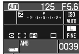
Cet appareil est doté d'un contrôleur automatique de niveau de charge de la batterie. Lorsque l'appareil est sous tension, une icône est affichée sur l'écran de contrôle. L'icône de l'écran ACL passe du blanc au rouge lorsque la charge de la batterie est faible. Certaines fonctions de l'appareil peuvent être indisponibles en cas de batterie faible. Si l'écran n'affiche plus rien, la batterie est peut-être épuisée.
