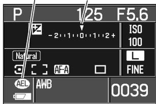
Tout en maintenant la touche AEL, placer le sujet dans la zone de mise au point et appuyer à mi-course sur le déclencheur pour faire la mise au point (2). Appuyer à fond sur le déclencheur pour prendre la photo.
