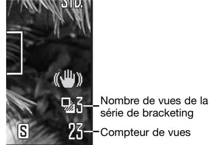
Le nombre de vues restantes de la série est affiché sur l'écran près de l'indicateur de bracketing. Si la mémoire est pleine ou si le déclencheur est relâché avant que la série soit terminée, l'appareil est réinitialisé et la série doit être entièrement recommencée. Si le témoin rouge de pile faible apparaît, le mode bracketing est annulé. Le flash ne peut pas être utilisé en mode bracketing.
