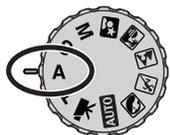
Le photographe choisit l'ouverture et l'appareil règle automatiquement la vitesse correspondante pour la bonne exposition. En mode priorité à l'ouverture, la valeur d'ouverture s'affiche à l'écran en bleu et un icône en forme de double-flèche apparaît à côté. Le mode flash peut être réglé sur flash forcé, flash forcé avec réduction des yeux rouges ou synchro lente avec réduction des yeux rouges (p. 26).
