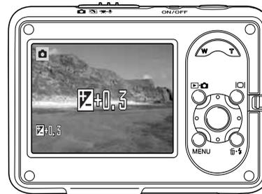
En mode Enregistrement, utiliser les touches haut/bas ou gauche/droite du contrôleur pour modifier la fonction sélectionnée avec le menu.
