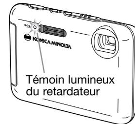
Pour interrompre le décompte, appuyez sur les touches zooming ou Menu. Après exposition, le mode d'entraînement revient sur l'avance vue par vue. Le signal sonore peut être désactivé dans l'onglet 2 du menu Réglages (p. 77).
