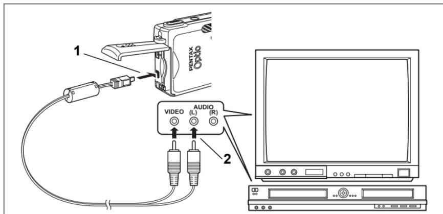
Le câble AV vous permet de visualiser et de doubler vos images sur un écran de téléviseur ou tout autre équipement à l'aide d'un connecteur IN vidéo. Veillez à ce que l'équipement AV et l'appareil soient tous les deux hors tension avant d'effectuer le branchement.
