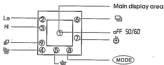
Appuyez sur le sélecteur de fonction pour choisir et utiliser la fonction désirée. Le diagramme des fonctions apparaît tel qu'illustré ci-dessus à l'écran ACL :
