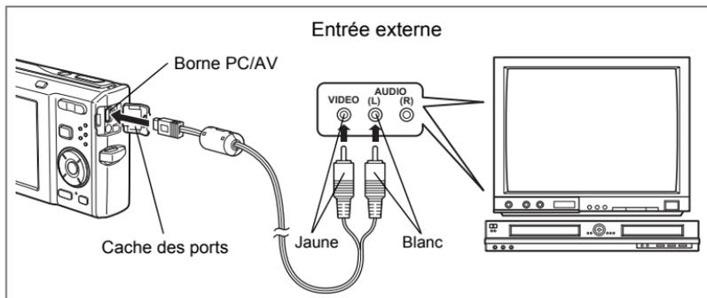
Le câble AV vous permet de visualiser vos images sur un équipement muni d'un connecteur IN vidéo, un téléviseur par exemple. Veillez à ce que l'appareil et le téléviseur soient hors tension avant de le raccorder au téléviseur.
