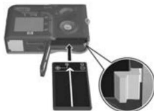
Pour retirer la batterie, vous devez d'abord éteindre l'appareil photo. Ouvrez ensuite le volet du compartiment de la batterie/ carte mémoire, libérez le loquet de la batterie et inclinez l'appareil photo ; la batterie glissera alors hors de son logement.
