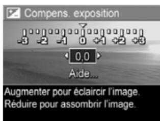
Si le paramètre sélectionné n'est pas le paramètre par défaut 0 (zéro), la valeur de ce paramètre est affichée sur l'écran de **prévisualisation** à côté de l'icône
