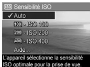
Si le paramètre sélectionné n'est pas le paramètre par défaut **Auto**, la valeur correspondant à ce paramètre apparaît sur l'écran de **prévisualisation**.
