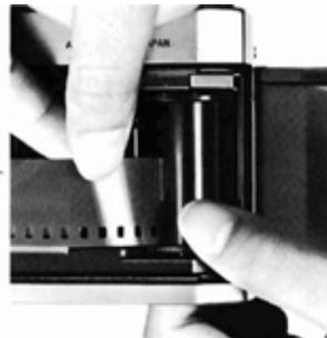
4. Actionnez le levier d'armement rapide et veillez à ce que le bouton de reboinage tourne en sens inverse des aiguilles d'une montre indiquant que le chargement a été correctement effectué et que le défilement du film se fait normalement. Déclenchez.
