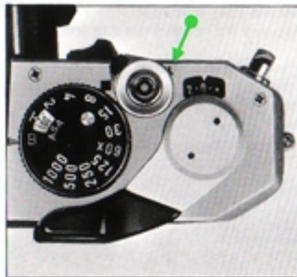
Tourner le barillet des vitesses dans un sens ou dans l'autre pour amener la vitesse d'obturation choisie en face du repère. Ce réglage peut se faire avant ou après l'armement. Lorsque l'on actionne le levier d'armement rapide, le voyant d'armement devient rouge dès que l'obturateur est armé. La couleur de l'indicateur d'armement devient noire après le déclenchement de l'obturateur. Pour utiliser la position de synchronisation X du barillet des vitesses, voir la page 18.
