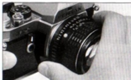
4. Pour déposer l'objectif, tenir l'appareil de la main gauche. Appuyer sur le bouton de déverrouillage E tout en tournant l'objectif de la main droite en sens inverse d'horloge.
