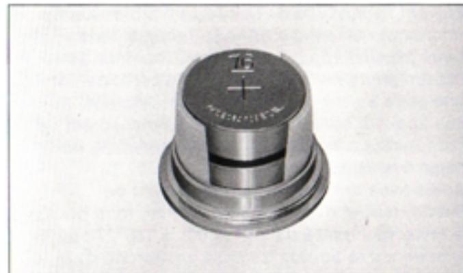
Les deux piles alcalines ou à l'oxyde d'argent du MX ne servent qu'à l'exposition du posemètre; la commande du mécanisme de l'obturateur est entièrement manuelle. De ce fait, il est possible de déclencher l'appareil même au cas où les piles seraient épuisées.
