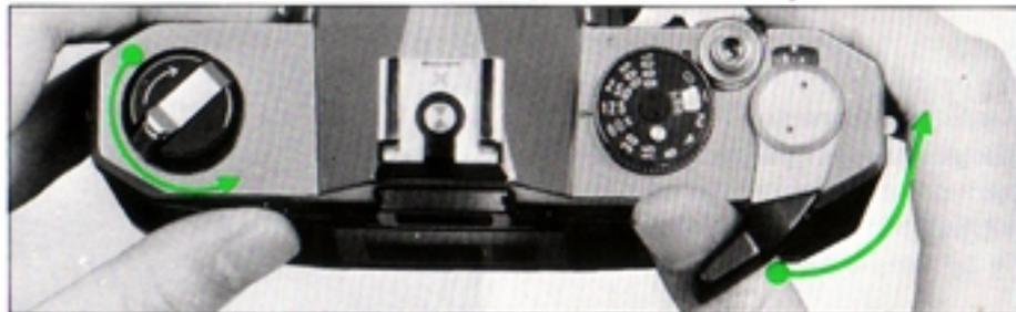
Déclencher l'obturateur. Avancer le film jusqu'à ce que le compteur de vues indique le chiffre "1", montrant ainsi que le premier cliché est prêt à être exposé.
