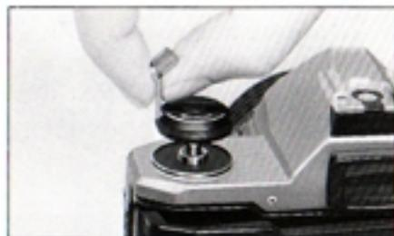
1. Tirer sur le bouton de rebobinage jusqu'à ce que le dos s'ouvre.
