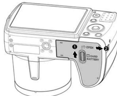
2. Déverrouillez et ouvrez le compartiment de la batterie/carte mémoire dessous l'appareil photo.
