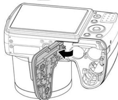
3. Insérez les piles dans le compartiment avec la borne dirigée vers l'intérieur de l'appareil photo et l'orientation correcte comme illustré.
