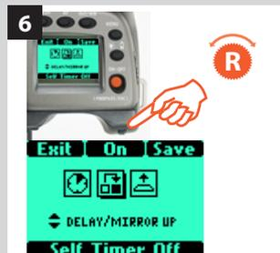
Mis en évidence : Mirror sequence (séquence du miroir). Option sélectionnée : delay first, then mirror raised (délai, puis levée du miroir).
