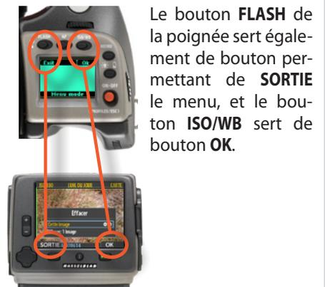
Le bouton **FLASH** de la poignée sert également de bouton permettant de **SORTIE** le menu, et le bouton **ISO/WB** sert de bouton **OK**.
