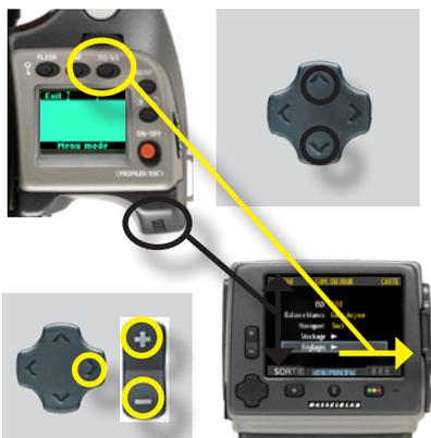
La molette arrière permet de monter et descendre dans la liste, tandis que la molette avant fait naviguer latéralement, dans le sens des flèches du menu.
