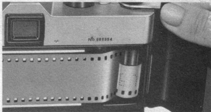
3. Insérer l'amorce du film dans la bobine réceptrice et faites la tourner jusqu'à ce que le film soit bien accroché. Assurez-vous que les dents de la roue dentée s'engagent dans les perforations du film.
