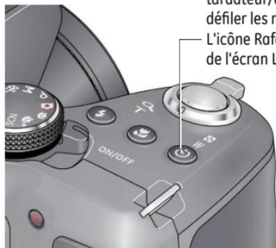
1. Appuyez sur le bouton du retardateur/de rafale jusqu'à ce que l'icône Rafale
