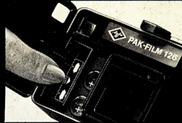
Batteriewechsel: Rückdeckel öffnen (1), Filmaushebelklappe niederdrücken, 2 Varta 246 oder Mallory Mn 625 G mit + Pol nach oben einsetzen.
