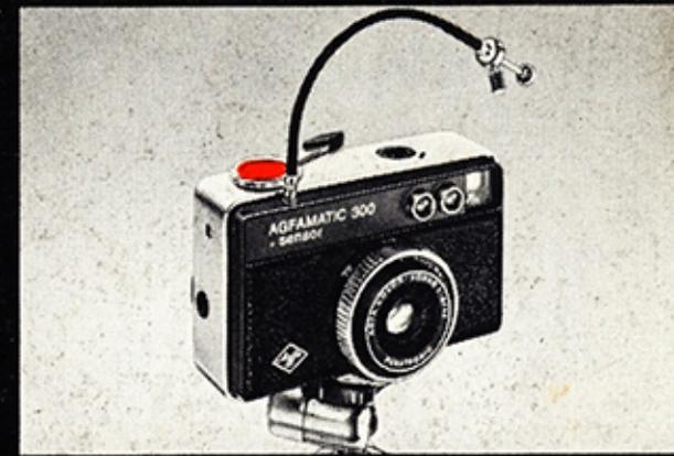
Bei langen Zeiten (ab 1/30 sec) leuchtet beim Antippen des Sensors im Sucher unten eine rote Lampe auf: jetzt Stativ verwenden.
