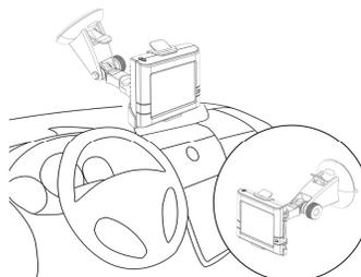
**Attention:** Veillez à installer le support de voiture de façon à ce qu'il ne gêne pas la conduite, n'obstrue pas la vision du conducteur et le déploiement des airbags.
