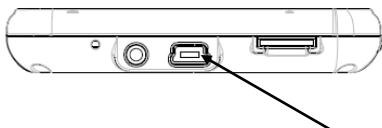
Port USB (connexion PC et chargement de la batterie) derrière la trappe.
