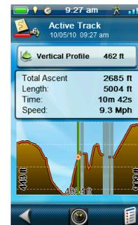
L'écran de l'altimètre affiche des informations détaillées sur l'altitude au moyen du signal GPS ou des senseurs intégrés mesurant l'altitude (eXplorist 610 /710). La zone du graphique peut être élargie en touchant l'icône dans le coin inférieur droit et en définissant la zone à utiliser. De plus, une ligne peut être déplacée le long du graphique pour localiser un point exact sur le graphique et afficher les informations détaillées de ce point.
