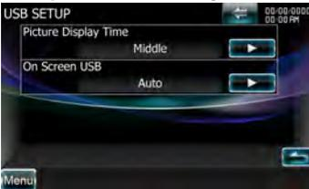
**[Picture Display Time]** Sélectionne une durée d'affichage de l'image. (☑ "Long")
