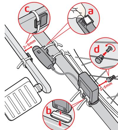
2. Vérifiez que les aimants sont alignés avec la zone de détection sur les capteurs.
