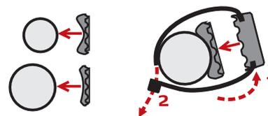
2. Alignez le loquet au dos de l'appareil avec la fente sur le support vélo, puis faites pivoter l'appareil vers la droite pour le verrouiller sur le support vélo. Vous pouvez choisir de monter l'appareil sur le guidon (a) ou sur la tige (b). Consultez les exemples suivants de montage de l'appareil.
