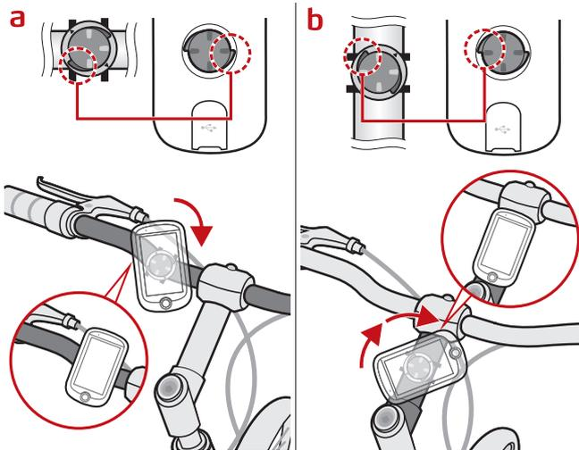
3. Pour retirer l'appareil du support vélo, faites-le pivoter vers la gauche.
