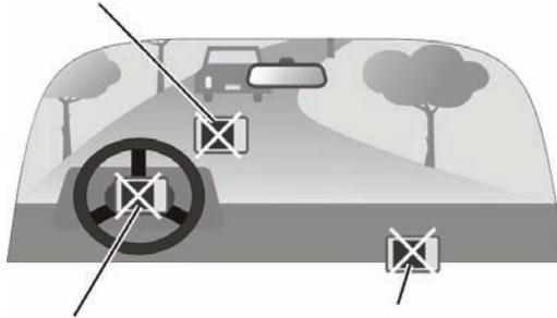
Ne pas monter l'appareil sur les panneaux des airbags.
