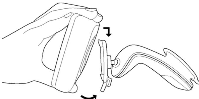
Au dos de l'appareil de navigation, un cercle à deux encoches est visible.
