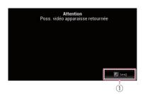
① Bascule l'affichage entre l'image de la caméra de rétrovisée et l'image de la 2ème caméra.
