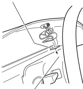
Installez l'agrafe pour micro sur la colonne de direction, à distance du volant.
