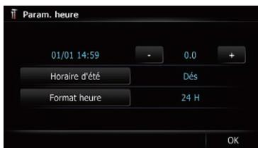
Le décalage horaire indique combien d'heures différent entre l'heure réglée à l'origine dans le système de navigation (heure d'Europe centrale) et la position actuelle de votre véhicule. Toucher **[+]** ou **[-]** change l'affichage du décalage horaire par incrément d'une demi-heure. Le décalage horaire peut être réglé de "**-4**" à "**+9**" heures.
