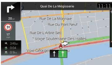
Les panneaux de signalisation sont affichés en haut de la carte. La couleur et le style des panneaux sont similaires aux vrais panneaux au-dessus ou sur le bord des routes. Ces panneaux affichent les destinations sélectionnées
