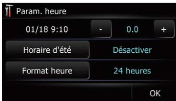
Le décalage horaire entre l'heure initialement réglée dans le système de navigation (Heure de l'Europe centrale) et l'emplacement actuel de votre véhicule est indiqué. Au besoin, ajustez le décalage horaire. Touchez [+] ou [-] pour modifier le décalage horaire par palier d'une demi-heure.
