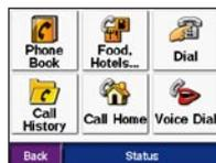
Appuyez sur **Status (Etat)** pour afficher la puissance de signal du téléphone connecté, le niveau de charge de la batterie, l'opérateur téléphonique et le nom.
