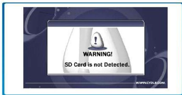
L'avertissement « SD Card is not detected » (Aucune carte SD détectée) s'affiche lorsque la carte SD/MMC n'est pas correctement insérée dans le slot pour carte de l'appareil.
