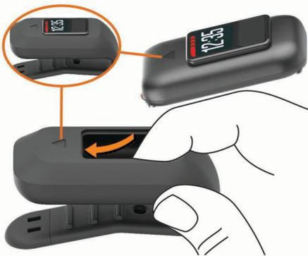
Pour retirer l'appareil du clip ceinture, attrapez les deux côtés du clip ceinture et tordez-les chacun dans un sens différent. Retirez l'appareil en étirant le clip autour de l'appareil.
