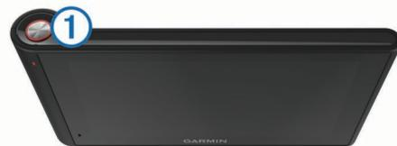
L'appareil enregistre une photo ainsi que la séquence vidéo avant, pendant et après la sélection du bouton. Le voyant clignote rouge pendant l'enregistrement de la séquence vidéo.
