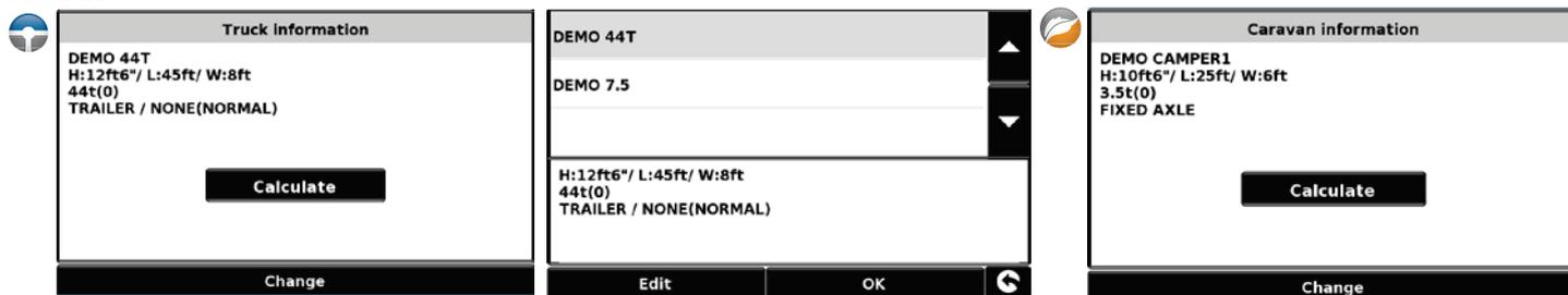
S'il s'agit du véhicule approprié, appuyez sur « **Calculer** ». Pour changer de véhicule, appuyez sur « **Change** » (Modifier).
