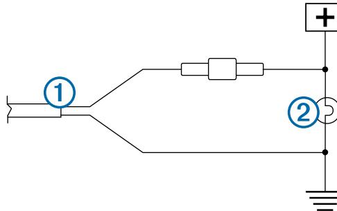
**OBS!** Om du ansluter sändaren till en strömkälla med 12–24 V likström (t.ex. en varsellampa) istället för en backlampa måste du sätta på strömmen till sändaren manuellt. Sändaren kan ta slut på batteriet i ditt fordon om den lämnas påslagen.
