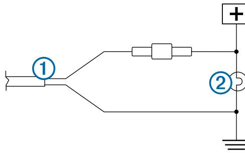
**NOTA:** il collegamento del trasmettitore a una fonte da 12-24 V CC fissa (come un DRL) invece che a una lampadina della retromarcia, richiede di attivare manualmente il trasmettitore tramite un interruttore. Se lasciato acceso, il trasmettitore potrebbe consumare la batteria del veicolo.
