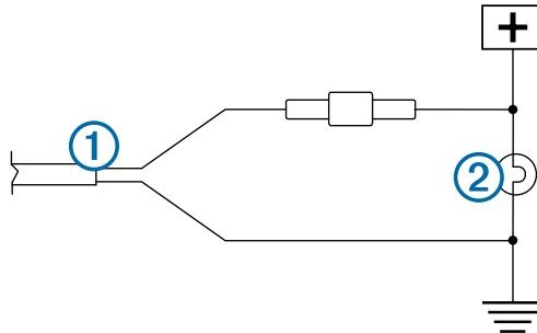
**MERK:** Koble senderen til en kontinuerlig kilde på 12–24 VDC (for eksempel en kjørelampe) i stedet for en ryggelys som krever at du veksler strøm til senderen manuelt. Senderen kan tømme kjøretøyets batteri hvis den ikke slås av.
