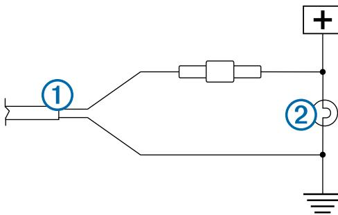
**NOTA:** se ligar o transmissor a uma fonte de alimentação permanente de 12 a 24 V CC (por exemplo, às luzes de circulação diurna), e não à luz de marcha atrás, terá de ligar e desligar manualmente a alimentação do transmissor. Se deixar o transmissor ligado, este poderá descarregar a bateria.
