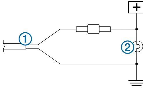
**HUOMAUTUS:** kun lähetin liitetään pysyvään 12–24 VDC:n virtalähteeseen (kuten huimovaloon) eikä peruutusvaloon, virta on kytettävä manuaalisesti lähettimeen. Lähetin voi tyhjentää ajoneuvon akun, jos se jätetään päälle.
