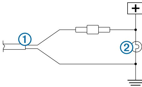
**UWAGA:** Podłączenie nadajnika do zawsze włączonego źródła zasilania prądem stałym o napięciu 12–24 V (np. lampy światła do jazdy dziennej), zamiast do lampy światła cofania, wymaga ręcznego włączania zasilania nadajnika przez użytkownika. Pozostawienie włączonego nadajnika może spowodować całkowite rozładowanie akumulatora pojazdu.
