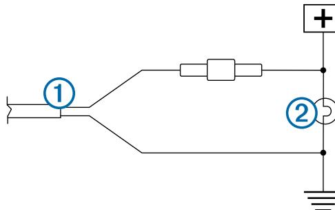
**BEMÆRK:** For tilslutning af transmitteren til en konstant 12-24 V DC-kilde (f.eks. køreløset) i stedet for baklygten skal du koble strøm til transmitteren manuelt. Transmitteren kan dræne køretøjets batteri, hvis den forbliver tændt.
