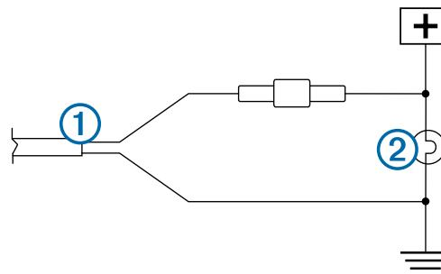
**HINWEIS:** Wenn Sie den Sender mit einer dauerhaft mit Strom versorgten 12- bis 24-Volt-Gleichstromquelle verbinden und nicht mit einem Rückfahrlicht, müssen Sie die Stromversorgung des Senders manuell herstellen. Der Sender kann zu einem Entladen der Fahrzeughilfsbatterie führen, falls er nicht ausgeschaltet wird.
