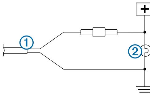
**NOTA:** si conectas el transmisor a una fuente estable de 12-24 V de CC (como una lámpara de circulación diurna) en vez de a una luz de marcha atrás deberás desactivar de forma manual la alimentación al transmisor. El transmisor puede agotar completamente la batería del vehículo si lo dejas encendido.
