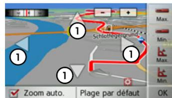
→ A l'aide des touches fléchées, réglez ① l'angle d'inclinaison 1 maximal souhaité.
