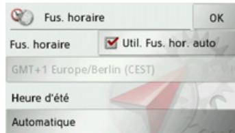
La touche à côté de **Fus. horaire**, vous permet de déterminer si le fuseau horaire doit être automatiquement réglé par Traffic Assist ou non (fonction automatique activée fonction automatique désactivée ).
