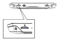
Le logement de carte se trouve sur le côté gauche du dessous de l'appareil. Il est équipé d'un mécanisme d'encliquetage et d'éjection à ressort. > D
