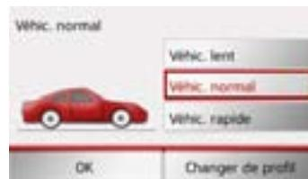
Vous avez la possibilité ici de sélectionner les différents profils voitures à l'aide des touches **Véhic. lent**, **Véhic. normal** et **Véhic. rapide**.
