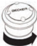
> Maintenez la partie inférieure de la télécommande et tournez celle-ci dans le sens inverse des aiguilles d'une montre jusqu'à ce qu'elle puisse se détacher du socle.
