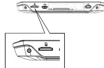
Le logement de carte se trouve sur le côté gauche du dessous de l'appareil. Il est équipé d'un mécanisme d'encliquetage et d'éjection à ressort.
